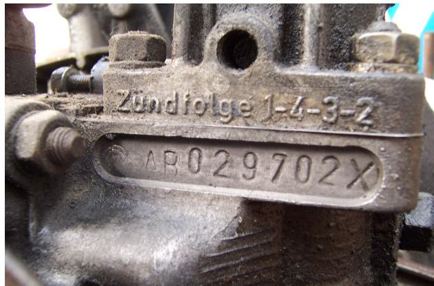
A partir do número do motor, pode determinar o tipo de motor e a cilindrada do motor.
