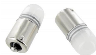
Stadslicht, achterlicht, kentekenplaat en binnenverlichting LED lampje 6V (per paar) type: bajonet, Voet: BA15s, Kleur: helder, Spanning: 6V, Vermogen: 1.8 Watt (vervangt 10 Watt)
