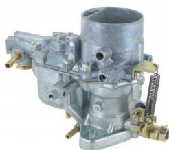
EMPI EPC 34 carburateur (per stuk) Hoofdsproeier: 150, Luchtsproeier: 175, Stationairsproeier: 55, Emulsie buis: F6
