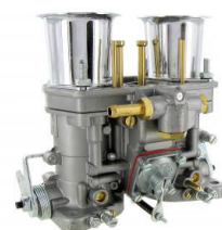
EMPI HPMX 40 carburateur (per stuk) Hoofdsproeier: 130, Luchtsproeier: 170, Stationairsproeier: 52, Emulsie buis: F11, Venturi: 28
