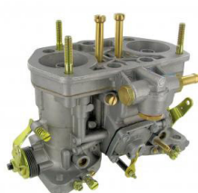
Weber IDF 40 carburateur (per stuk) Hoofdsproeier: 115, Luchtsproeier: 200, Stationairsproeier: 50, Emulsie buis: F11, Venturi: 28mm
