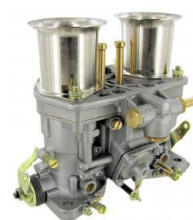
Weber IDF 44 carburateur (per stuk) Hoofdsproeier: 135, Luchtsproeier: 175, Stationairsproeier: 50, Emulsie buis: F11, Venturi: 36mm
