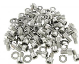
RVS inbus koelbeplating boutjes inclusief ringen (50 stuks) Schroefdraadmaat: M6 x 1.0, Lengte: 10mm, Materiaal: RVS A2, Treksterkte: 70, Sleutelmaat: 5mm, Ring diameter: 11.70mm
