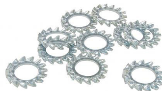
Externe tandveerringen M8 (10 stuks) Binnendiameter: 8,4mm, Buitendiameter: 15mm, Hoogte: 2.4mm, Materiaal: gegalvaniseerd staal
