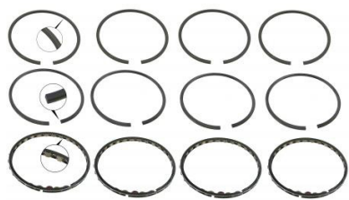
Standaard zuigerveren set Waterboxer motor 2100cc, Boring: 94.0mm, Dikte bovenste compressie ring: 1.75mm, Dikte onderste compressie ring: 2.00mm, Dikte olieschraapveer: 3.50mm
