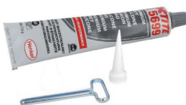
SI 5699 grijze siliconen pakking Inhoud: 80 ml, Kleur: grijs, Chemische soort: Oxime Siliconen, Maximale afdichtingsruimte: 1.0mm, Temperatuurbereik: -60 °C naar +200 °C
