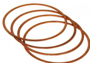
Koperen cilinderkop vulringen (4 stuks) type-1 motoren, type- 3 motoren, CT/CZ motoren, Dikte: 1.016mm, Buitendiameter: 98mm, Boring: 90.5 en 92.0mm, Materiaal: koper
