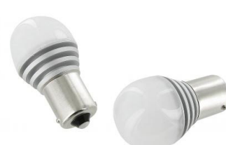
Richtingaangever LED lampje 12V amber (per paar) type: bajonet, Voet: BA15s, Kleur: amber (oranje), Spanning: 12V, Vermogen: 2.5 Watt (vervangt 21 Watt)
