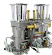
EMPI HPMX 44 carburateur (per stuk) Hoofdsproeier: 135, Luchtsproeier: 200, Stationairsproeier: 55, Emulsie buis: F11, Venturi: 36
