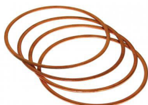
Koperen cilinderkop vulringen (4 stuks) type-1 motoren, type- 3 motoren, CT/CZ motoren, Dikte: 1.27mm, Buitendiameter: 98mm, Boring: 90.5 en 92.0mm, Materiaal: koper
