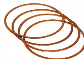
Koperen cilinderkop vulringen (4 stuks) type-1 motoren, type- 3 motoren, CT/CZ motoren, Dikte: 1.524mm, Buitendiameter: 98mm, Boring: 90.5 en 92.0mm, Materiaal: koper
