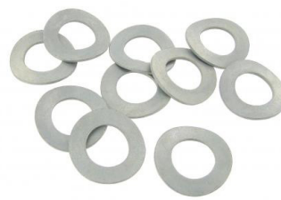
Gegolfde M12 veerringen (10 stuks) Binnendiameter: 13mm, Buitendiameter: 24mm, Dikte: 1.2mm, Materiaal: gegalvaniseerd staal
