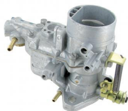
Weber 34 ICT carburateur (per stuk) Hoofdsproeier: 135, Luchtsproeier: 160, Stationairsproeier: 55, Emulsie buis: F6, Naaldklep: 150, Luchtcorrector: 40
