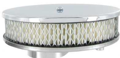
Super laag luchtfilter voor de orginele Solex carburateur Diameter: 162mm, Hoogte: 57mm, Carburateur halsmaat: 51mm, Carterontluchting aansluiting: 13mm
