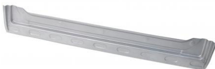
Schuifdeur reparatie plaat binnenzijde T25/T3 Bus
