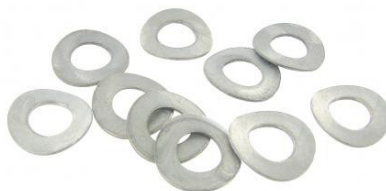
Gegolfde M10 veerringen (10 stuks) Binnendiameter: 10.5mm, Buitendiameter: 21mm, Dikte: 1.0mm, Materiaal: gegalvaniseerd staal
