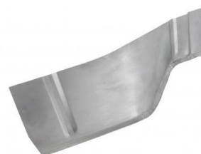
Reparatiedeel voorste wielkast rechter voorzijde Bus 4.1955 t/m 7.1967
