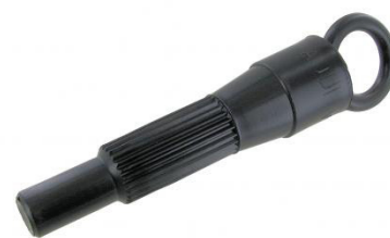
Koppelingsplaat richtgereedschap type-1 motor met een handgeschakelde versnellingsbak, type-3 motor, CT/CZ motor, Diesel motor
