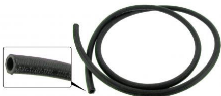
Ontluchtingsslang met textiel buitenzijde (per meter) Binnendiameter: 12mm, Buitendiameter: 17mm, Working pressure: 7 bar, Bursting pressure: 30 bar
