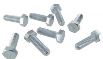
M8 zeskantbouten (8 stuks) Schroefdraadmaat: M8 x 1.25, Lengte: 25mm, Treksterkte: 10.9, Materiaal: gegalvaniseerd staal, Sleutelmaat: 13mm
