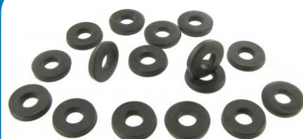
Onderlegringen M8 (16 stuks) Binnendiameter: 8.4mm, Buitendiameter: 21mm, Dikte: 4mm, Materiaal: onbehandeld staal
