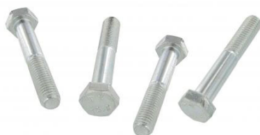
M8 zeskantbouten (4 stuks) Schroefdraadmaat: M8 x 1.25, Lengte: 50mm, Treksterkte: 10.9, Materiaal: gegalvaniseerd staal, Sleutelmaat: 13mm
