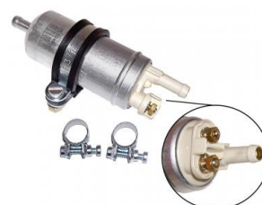
Benzinepomp elektrisch (A-kwaliteit) 12V, 0.27 - 0.38 bar, 90 l/h
