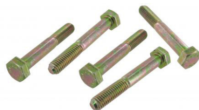
M8 zeskantbouten (5 stuks) Schroefdraadmaat: M8 x 1.25, Lengte: 55mm, Treksterkte: 10.9, Materiaal: gegalvaniseerd staal, Sleutelmaat: 13mm
