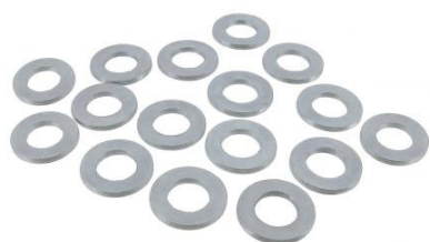
Onderlegringen M10 mm (16 stuks) Binnendiameter: 10.5mm, Buitendiameter: 21mm, Dikte: 2mm, Materiaal: gegalvaniseerd staal, Hardheid: 300 HV
