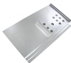
Cabine veiligheidsgordel montageplaats reparatiedeel links Bus 8.1967 t/m 7.1979
