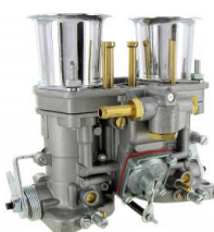
EMPI HPMX 40 carburateur (per stuk) Hoofdsproeier: 130, Luchtsproeier: 170, Stationairsproeier: 52, Emulsie buis: F11, Venturi: 28
