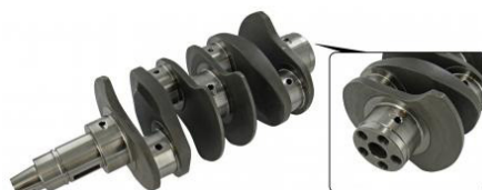
71 mm krukas met contragewichten type-4 motoren
