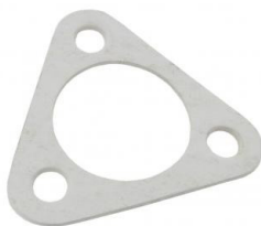
Pakking spaghetti uitlaatspruitstuk op demper (per stuk) Bout afstand: 58mm, Binnendiameter: 44.70mm
