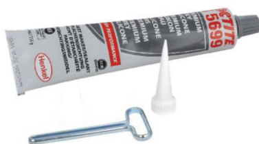
SI 5699 grijze siliconen pakking Inhoud: 80 ml, Kleur: grijs, Chemische soort: Oxime Siliconen, Maximale afdichtingsruimte: 1.0mm, Temperatuurbereik: -60 °C naar +200 °C
