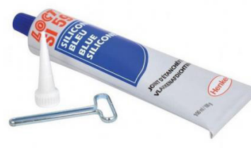
SI 5926 blauwe siliconen pakking Inhoud: 100 ml, Kleur: blauw, Chemische soort: Acetoxy Siliconen, Maximale afdichtingsruimte: 1.0mm, Temperatuurbereik: -54 °C naar +150 °C
