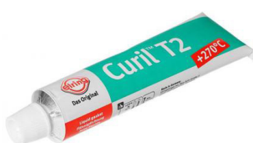
Curil T2 vloeibare pakking Inhoud: 70 ml, Kleur: groen, Maximale afdichtingsruimte: 0.2mm, Treksterkte: 0.034 N// mm 2 , Temperatuurbereik: -55 °C naar +250 °C (voor 24 uur tot +270 °C)
