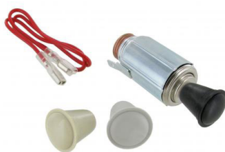
Sigarettenaansteker met 3 verschillende kleuren knoppen Spanning: 6V-12V, Montagegat: 22-25mm, Plaatdikte: maximaal 8mm
