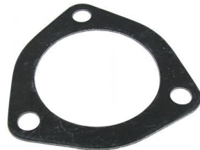
Pakking spaghetti uitlaatspruitstuk op demper (per stuk) Bout afstand: 78mm, Binnendiameter: 68mm
