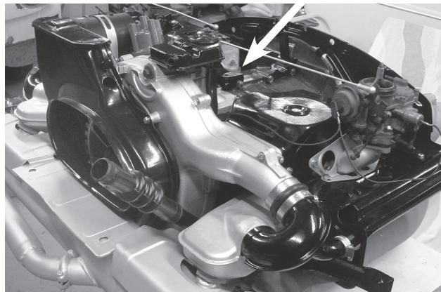
Il est important de savoir quel moteur est installé lorsque vous souhaitez commander des pièces. Tous les modèles 1500 Type 3 ne sont pas équipés d'un moteur 1500 cm<sup>3</sup>. De nombreux moteurs sont interchangeables, souvent sans modification du châssis ou de la carrosserie, il y a donc de fortes chances que votre voiture soit équipée d'un moteur différent. Soit un moteur de plus grande cylindrée, soit un moteur d'une autre année.
