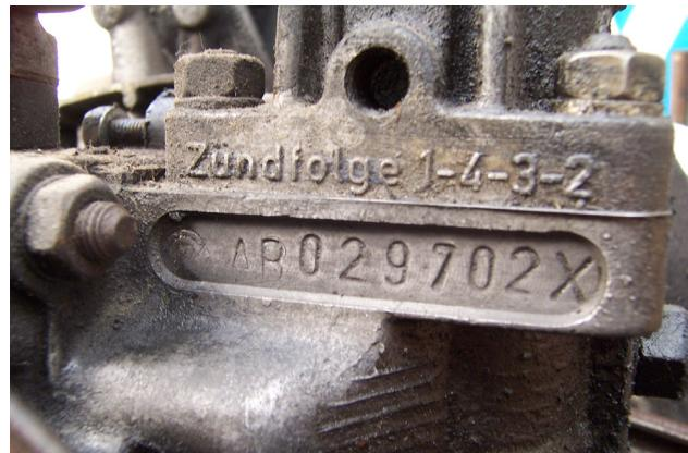
Il est important de connaître le type de moteur de votre voiture si vous souhaitez commander des pièces détachées. Tous les Combi T1 1200 ne sont pas équipées d'un moteur 1200 cm<sup>3</sup>. De nombreux moteurs sont interchangeables, souvent sans qu'il soit nécessaire de modifier le châssis ou la carrosserie. Il y a donc de fortes chances que votre voiture soit équipée d'un autre moteur. Soit un moteur avec une cylindrée plus importante, soit un moteur d'une autre année de construction.
