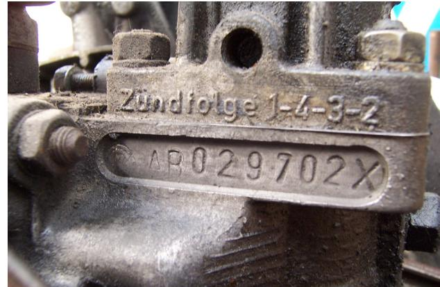
Wenn Sie Ersatzteile bestellen möchten, ist es wichtig zu wissen, welcher Motor eingebaut ist. Nicht jeder 1200 Beetle hat einen 1200-ccm-Motor. Viele Motoren sind austauschbar, oft ohne Änderungen am Fahrgestell oder an der Karosserie, sodass die Wahrscheinlichkeit groß ist, dass Sie einen anderen Motor in Ihrem Auto haben. Entweder einen Motor mit größerem Hubraum oder einen Motor aus einem anderen Baujahr.
