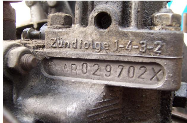
Es ist wichtig, den Motortyp Ihres Fahrzeugs zu kennen, wenn Sie Ersatzteile bestellen möchten. Nicht alle T1 Bus 1200 sind mit einem 1200-cm<sup>3</sup>-Motor ausgestattet. Viele Motoren sind austauschbar, oft ohne dass das Fahrgestell oder die Karosserie verändert werden müssen. Es ist also sehr wahrscheinlich, dass Ihr Fahrzeug mit einem anderen Motor ausgestattet ist. Entweder einen Motor mit größerem Hubraum oder einen Motor aus einem anderen Baujahr.
